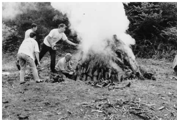
Figura 12. Terminando de armar la carbonera masoniega.
