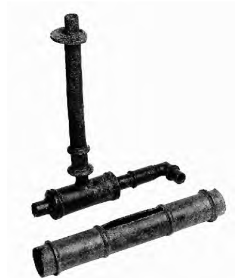
Lámina XVIII: Bomba de Ctesibio de bronce de procedencia desconocida. Antiquarium Comunale del Celio, Roma (Inv. 31035, 31036, 31038, 31045).
