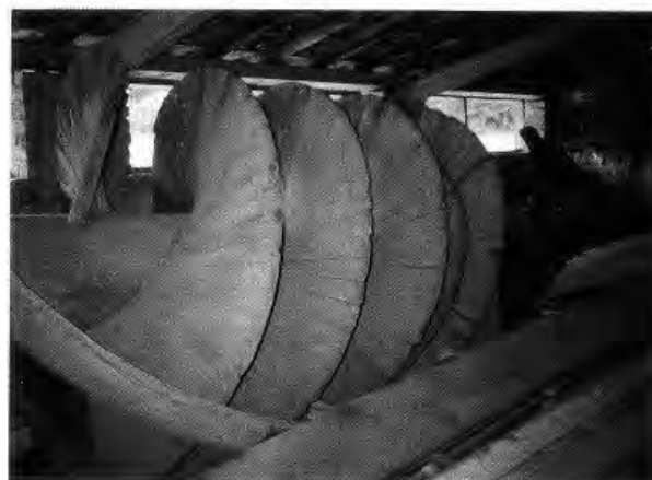
Lámina XIV: Dibujo y reproducción del tornillo de Arquímedes (sg. GONZÁLEZ TASCÓN y VELÁZQUEZ, 2005: 361).
