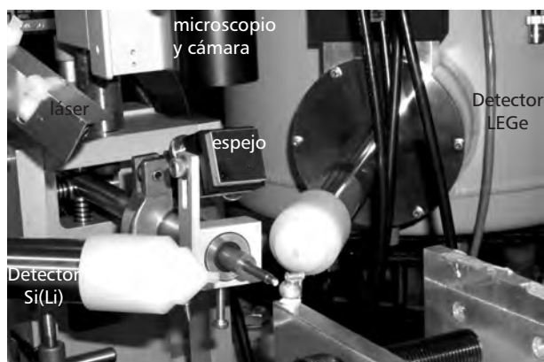
Lámina II: Imagen de la parte final de la línea de haz externo del CNA donde se pueden observar los diferentes elementos que sirven para el posicionamiento y visualización de la muestra, así como los detectores de rayos X.
